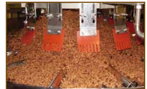
Die Mehrkopf-Waage dosiert die Nudeln so, dass exakt die richtige Menge abgefüllt wird.
